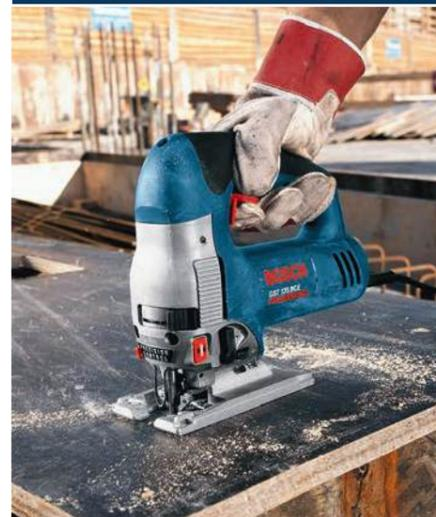
透過鋸條兩側的夾鉗收緊，限制鋸條左右擺動，以達到精確切割的效果。
