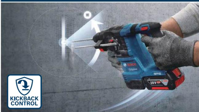
當鎚鑽進行作業被卡牢或者硬物夾住時，保護感測器偵測到由速度驟降帶來的加速度變化，會立即發送信號制停工具，保護使用者。
