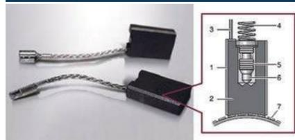
當碳刷將近耗盡時，彈簧會將絕緣頭頂出，碳刷與轉子的換向器斷路，自動停機。自動斷路碳刷保護轉子不受損壞。
