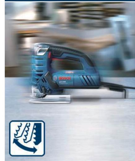
鋸片擺動能提升切割速度（橢圓切割行程增加進刀量），提高切割效率，但切口會比較粗糙，適合粗略切割。
