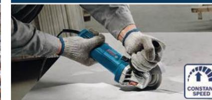
電動工具採用的單相串激電機隨負載增大，轉速會大幅下降。恆速控制裝置通過速度傳感器反饋給晶閘管，一旦降速便增加電機的端電壓，確保轉速不會大幅度衰減，實現恆速穩定。
