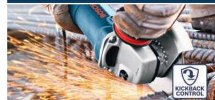
當角磨機進行垂直切割或窄角打磨時，砂輪片一旦被鋼筋卡住或硬物夾停(瞬間)，會發生反彈意外。Kick Back Stop通過速度傳感器，一旦卡片(速度降零)，便會斷電停機，保護使用者。
