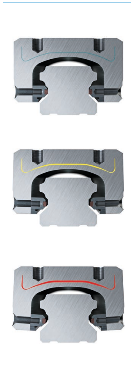
图 2: LBHS 施加液压压力的功能流程。图片上方:“已关闭”;中间:“打开”;下方:“已打开”
